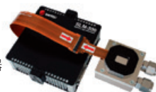
ハイパワーの対応が可能な光空間変調器 産業分野の応用が期待されています。
